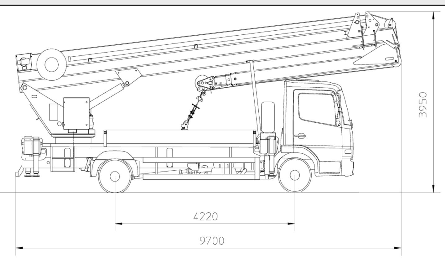
Der Böcker Autokran AK 35/3000 SPS wird auf einem LKW 7,49 t, z.B. DB 816/4x2/4220 aufgebaut. Über 4 hydraulisch steuerbare L-Stützen wird das Fahrzeug abgestützt. Die Stützbreite kann je nach Stützenstellung unabhängig voneinander variiert werden.
