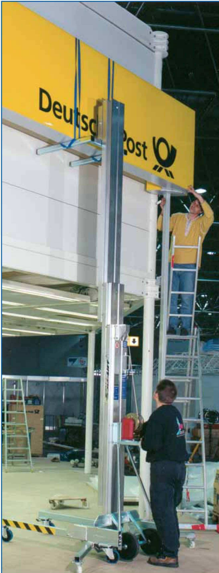
LM-Lift mit Handwinde, Nutzlast 300 kg, Förderhöhe bis zu 7,50 m
